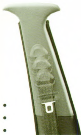
De bovenste bevestigingspunten van de driepuntsgordels voorin zijn in hoogte verstelbaar. De sluiting van de gordels is aan het stoel-frame bevestigd.
