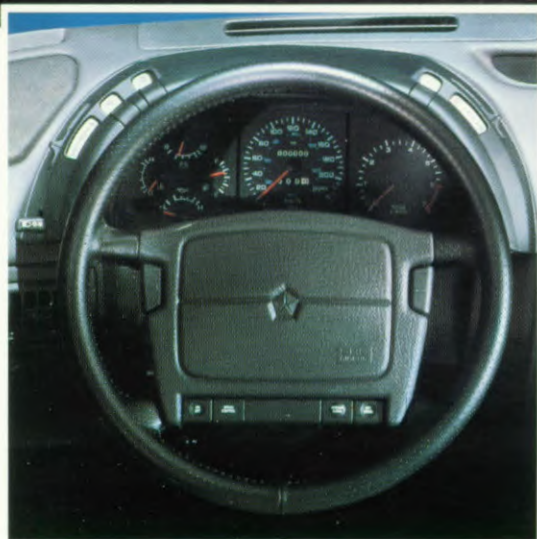
1 De elektronisch geregelde Speed Control is geïntegreerd in het stuurwiel.
