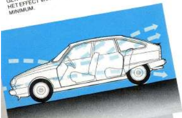
DE GSA HEEFT ROYALE VERWARMINGS- EN VENTILATIEROOSTERS. DOOR OPENINGEN IN DE ACHTERSTE DAKSTUJEN OF IN DE ACHTERPORTIEREN WORDT LUCHT DOOR HET INTERIEUR GEBLAZEN.
