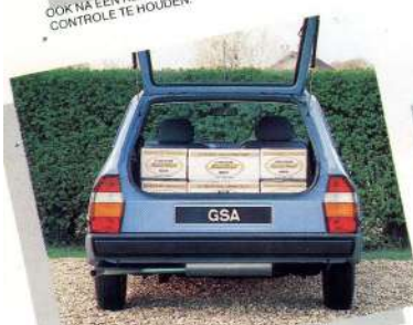
HET HYDROPNEUMATISCH VEERSYSTEEM ZORGT STEEDS VOOR DEZELFDE CARROSSERIEHOOGTE EN -STAND, ONGEACHT DE BELADING VAN DE AUTO, OP DIE MANIER BLIJVEN WENDBAARHEID EN AÉRODYNAMIEK OPTIMAAL.
