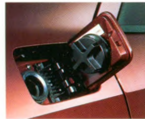
In de brandstofklep is een speciale uitsparing gemaakt voor de tankdop.
