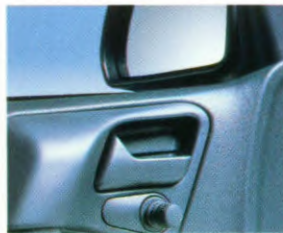
De buitenspiegels zijn handmatig van binnenuit verstelbaar.
