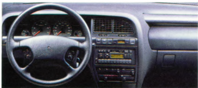
Het dashboard is gemaakt uit één stuk en is daarom vrij van rammeltjes; alle bedieningsorganen zitten binnen handbereik.
