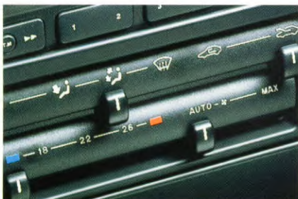
Temperatuur geregelde airconditioning.
