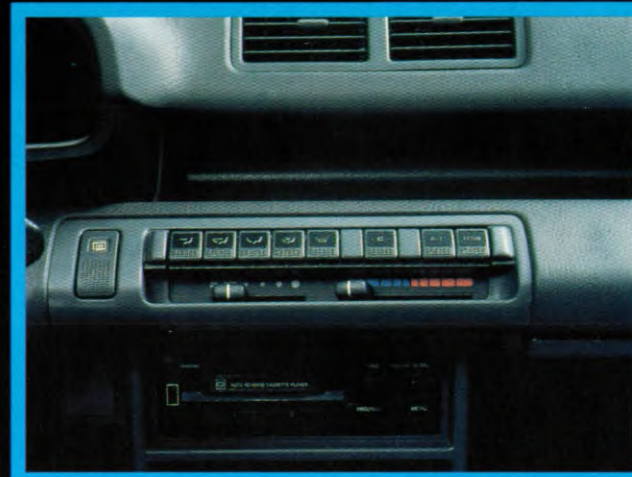
De Applause biedt ook de mogelijkheid tot druktoetsbediening voor verwarming en ventilatie (ABS Pack). Er is ook een ontwaseming van de zijruiten.
