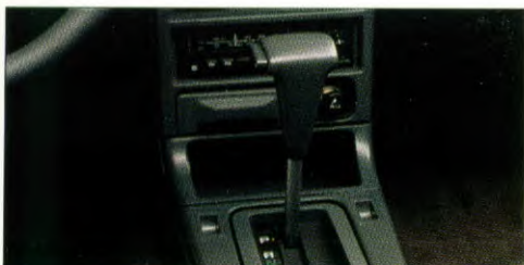
OOK LEVERBAAR ALS AUTOMAAT (3 VERSNELLINGEN) VOORZIEN VAN "LOCK UP" SYSTEEM. BIJ KRUISSNELHEDEN WORDT HIERMEE ONNODIGE SLIP VOORKOMEN EN EEN LAGER BRANDSTOFVERBRUIK VERKREGEN.
