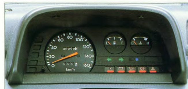
Het instrumentenpaneel met waarschuwingslampjes voor alle vitale functies, waaronder bij de automaat de selector stand.
