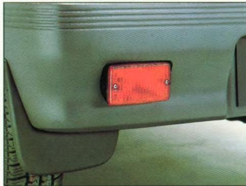
Mistachterlicht geïntegreerd in de bumper (TS, CS, TX). Spatlappen achter zijn optioneel.
