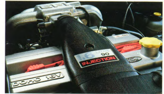
Gebouwd op basis van succesvolle Formule 1-techniek: de 1,6-liter DOHC 16V ZETEC motor met 66 kW/90 pk.
