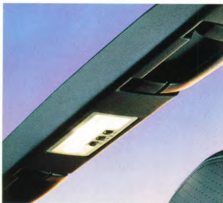
De rolbeugel bevat kaartleeslampjes, binnenvlichting en wegklapbare handgrepen.
