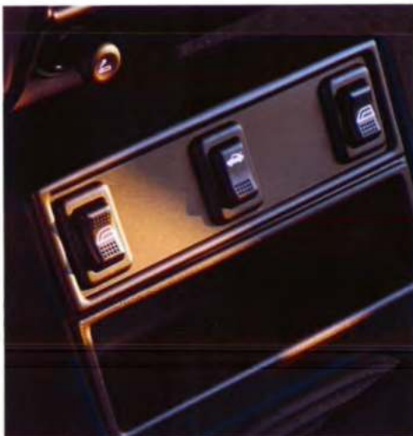
Elektrische voorportierramen en achterklepontgrendeling (standaard op Ghia en XR2i).
