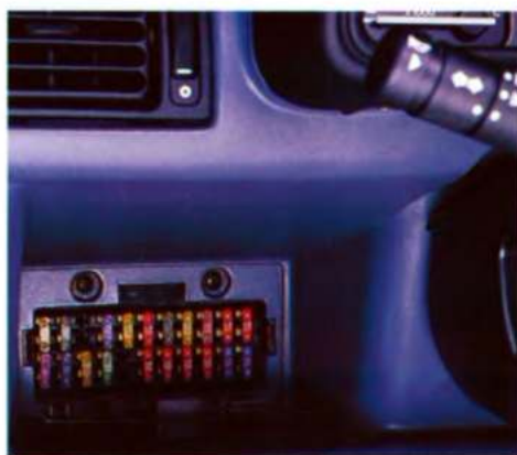
De zekeringen zijn gemakkelijk bereikbaar.
