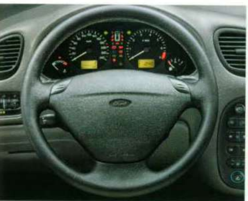
De ont koppeling van het stuurwiel maakt het stuur vrij van de stuurkolom. Daardoor is de besturing uitgeschakeld, ook wanneer dieven het stuurslot forceren.
