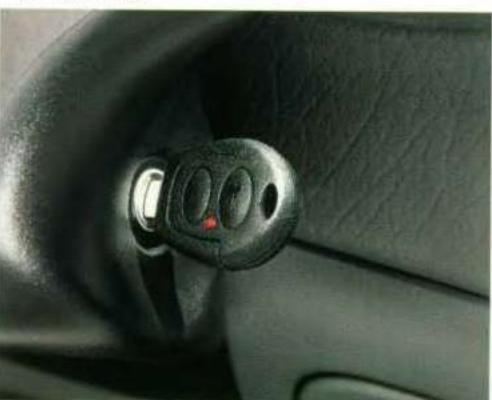
PATS elektronische startblokkering werkt via de sleutel.
