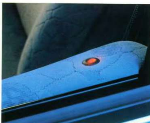
Een waarschuwingssignaal klinkt wanneer de dubbelwerkende vergrendeling is ingeschakeld. Bij gebruik van de infrarood afstandsbediening knippert een LED in het linkervoorportier.
