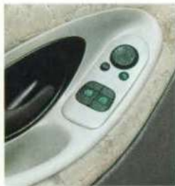
Elektrische bediening van de zijruiten voor en van de verwarmbare buitenspiegels.
