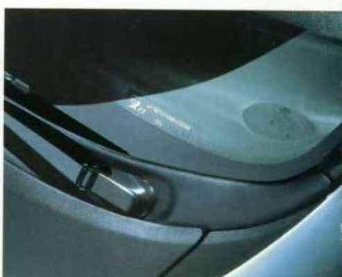
Het chassisnummer van de Galaxy is duidelijk zichtbaar achter de voorruit aangebracht.
