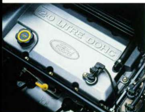
2,0-liter DOHC motor met 85 kW (115 pk).
