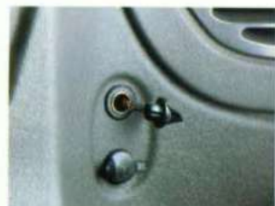
12-volt aansluitpunten achterin
