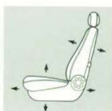
Verstelling voor-achterwaarts en in hoogte van de bestuurdersstoel. Ook de rugleuning is verstelbaar
