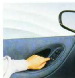
Elektrische bediening van de voorportierruit en van de verwarmbare buitenspiegels.
