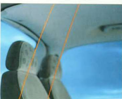
Als bescherming tegen vandalisme is de antenne van de Galaxy aangebracht in een van de achterste zijruilen. Doordat de antenne als dunne draad in het glas is geïntegreerd, hindert deze het zicht niet.
