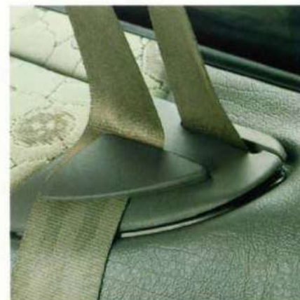
De veiligheidsgordels op de derde rij kunnen keurig worden weggeborgen wanneer de zitplaatsen niet worden gebruikt.
