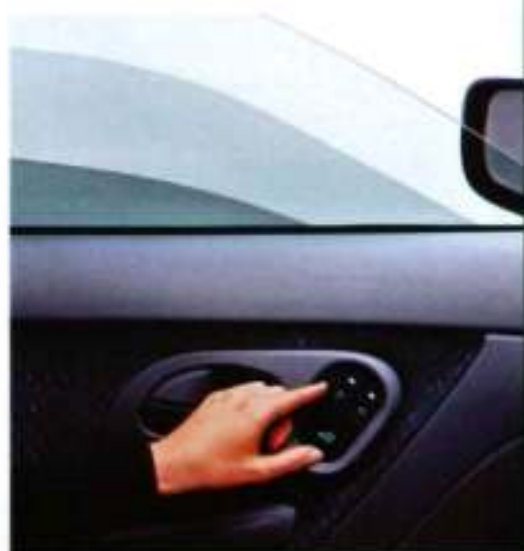
Elektrisch bedienbare ramen met verlichte optoetsbediening
