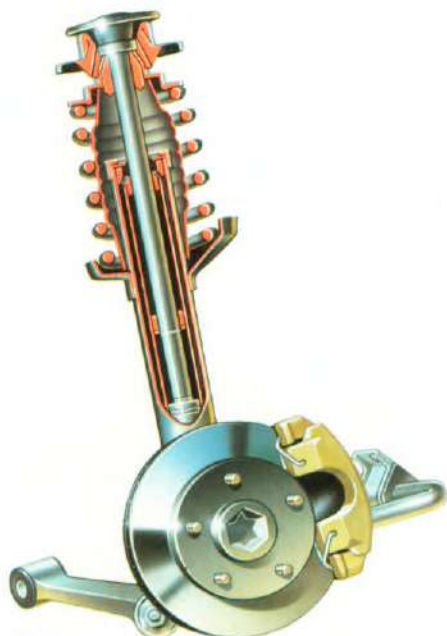
Boven: Gasgevulde schokdempers nu op alle modellen.
