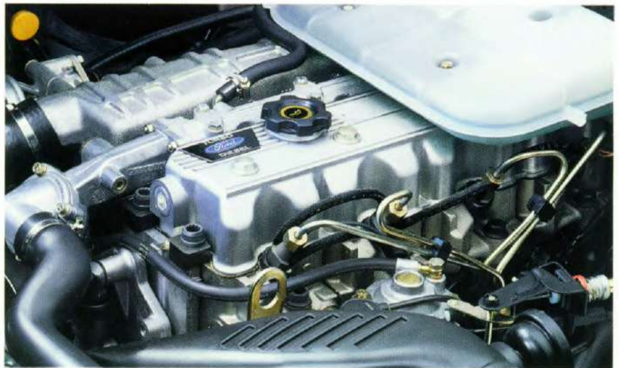
2,5 liter turbodieselmotor met 85 kW (115 pk).
