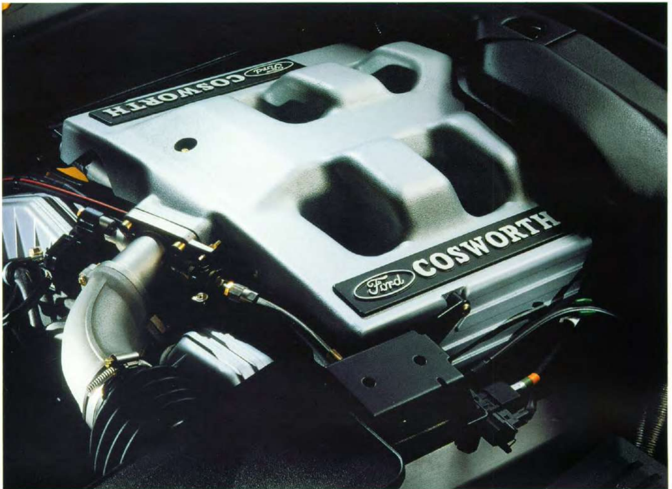
24V 2,9 liter EFI-motor met 143 kW (195 pk).
