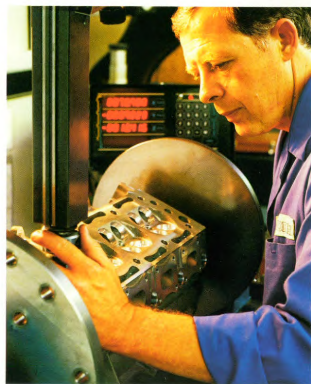
Inspectie van cilinderkop met behulp van computer
