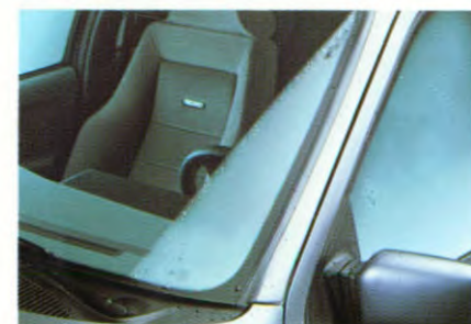
Voorruit met elektrisch snelontdooingsysteem
