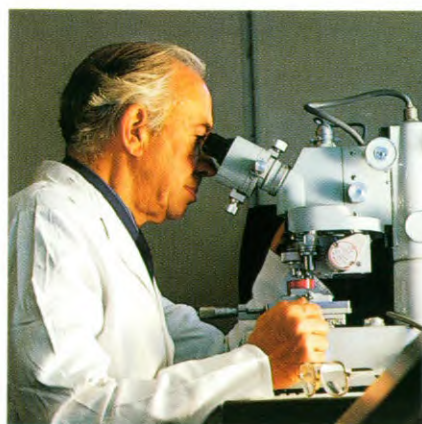
Hardheidsbepaling van klepstoters door indrukken van piramidevormige diamant
