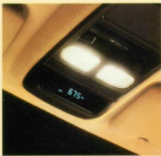
In de dakconsole is een groot aantal praktische voorzieningen opgenomen: een opbergplaats voor brillen, een display dat de buitentemperatuur weergeeft, een kompas, een multifunctionele trip-computer en leeslampjes voor zowel de voor- als achterpassagiers.
