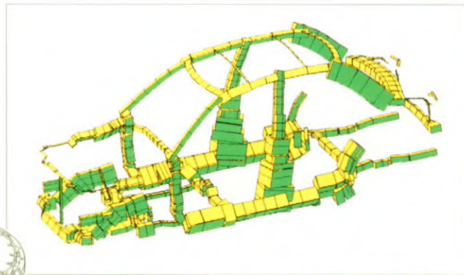
Geavanceerde computeranalyse voor een lichtere en stevigere carrosseriestructuur.
