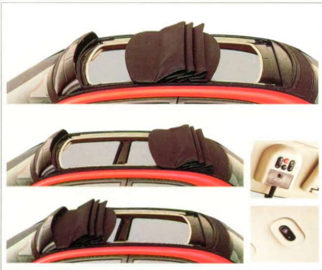
Met een schakelaar voorin en achterin kan het cabriodak van de Cabrio Top elektrisch geopend en gesloten worden.
