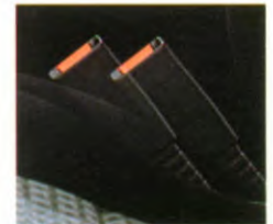
De bevestiging van de veiligheidsriemen in de nieuwe 323 is een voorbeeld van Mazda's zorg voor het vertrouwen en comfort van de bestuurder. Als de stoel wordt verzet, blijft de riem altijd op de juiste spanning, omdat die aan de stoel is bevestigd.
