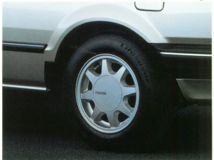
brede banden (175/70 SR 13) met aluminium velgen
