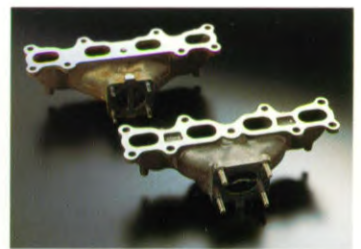
Twee verschillende uitlaatspruitstukken
