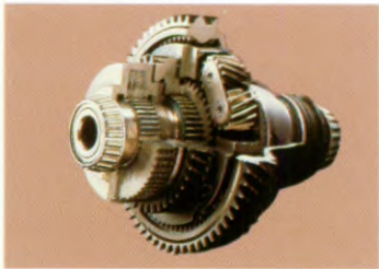
Differentieel met planetair tandwielstelsel
