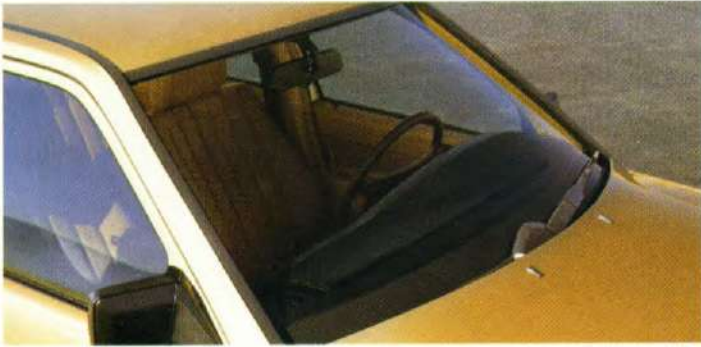
Aerodynamisch optimaal: de gelijkjnde voorruit.
