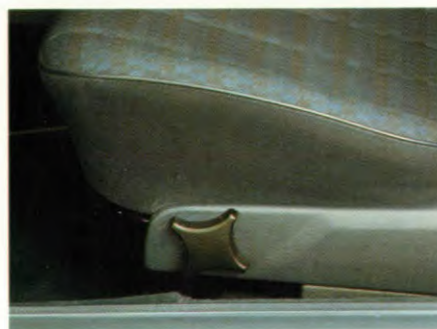
Het zitkussen is nu ook in hellingshoek verstelbaar. Daardoor kan de bestuurder de zetel exakt aan zijn lichaamsafmetingen aanpassen.
