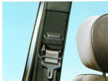
De middenstijlen hebben een nieuwe vormgeving en bekleding gekregen. De hoogteverstelling van de gordels is hierin geïntegreerd.
