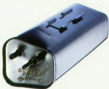
Het actief koolfilter verzamelt de brandstofdampen en voert deze bij draaiende motor weer terug naar het brandstofsysteem.
