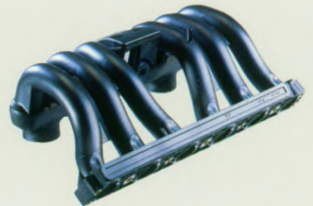
Het variabele inlaatspruitstuk zorgt bij de zescilinder motor voor een verbeterde cilindervulling.
