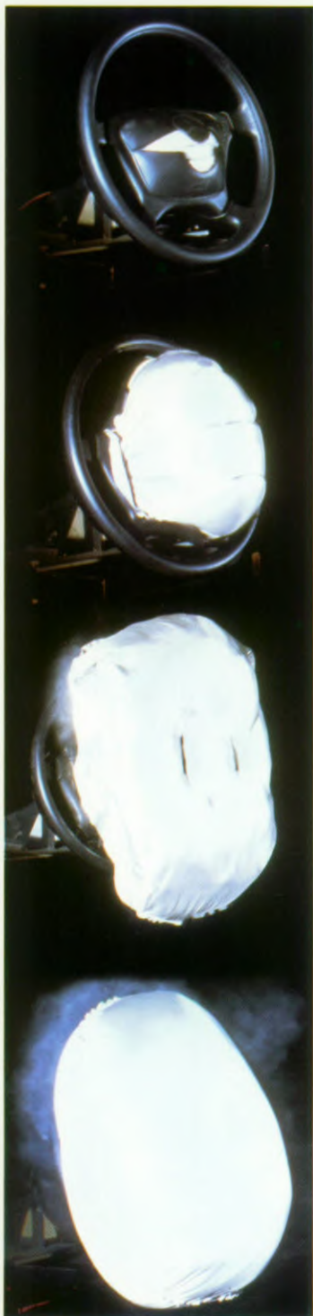
Ook in het als extra leverbare met hout en leder beklede stuurwiel is een full-size airbag gemonteerd, die in 0,03 seconde paraat is.
