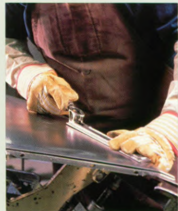
Bij het afwerken van de karrosserie worden terwille van de kwaliteit bepaalde werkzaamheden met de hand verricht.
