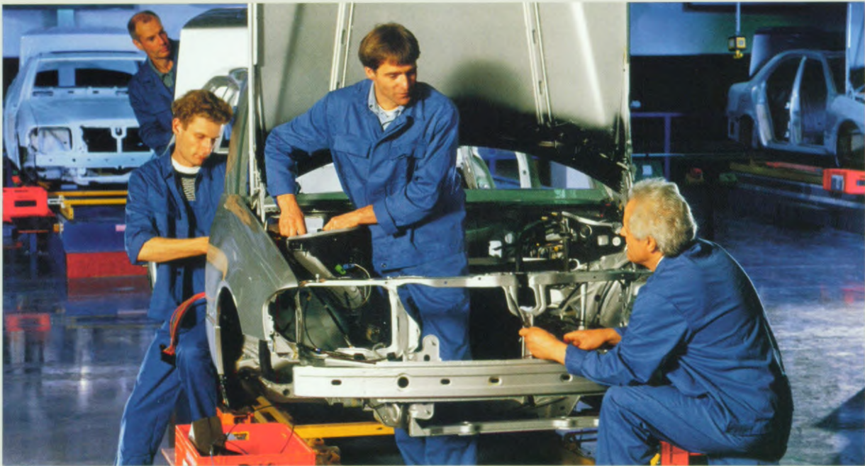
Een flexibele produktielijn voor de montage van de personenwagenkarrosserieën in onze fabriek te Sindelfingen.
