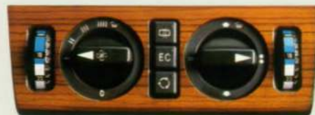
De bestuurder en de voorpassagier kunnen de door hen gewenste temperatuur afzonderlijk instellen.
