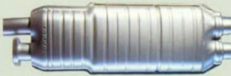
De geregelde drieweg-katalysator voor de benzinemodellen.
