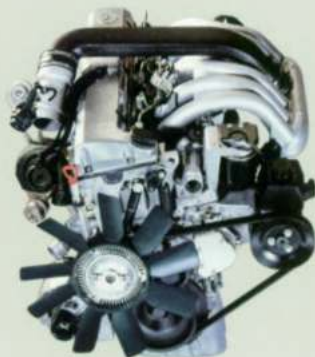
De zuinige vijfcilinder motor met directe inspuiting van de E 290 TURBODIESEL.
