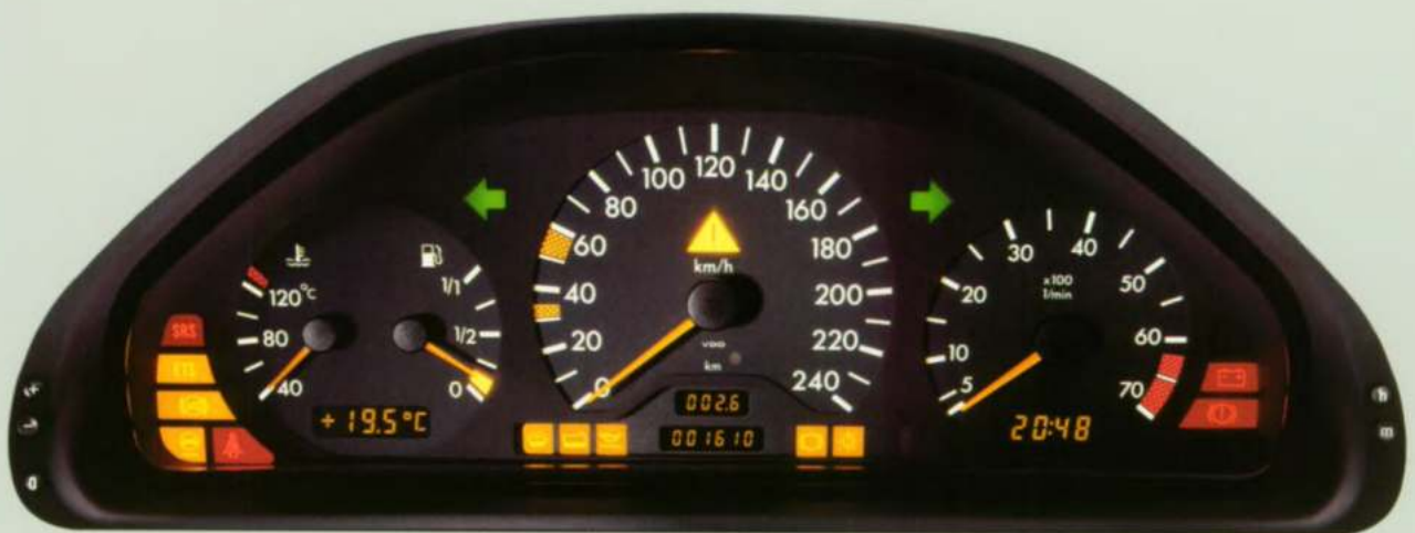
Veiligheid in één oogopslag: het nieuwe instrumentenpaneel met buitentemperatuurmeter en controlelampje voor ETS.
