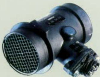
De luchtmassameter zorgt voor een optimaal brandstof-/luchtmengsel.
