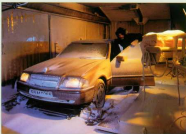
Het andere uiterste: onze auto's worden in de zogenaamde koudekamer „diepgevoren“.
