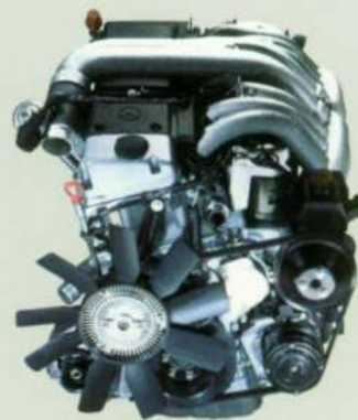
De stille zescilinder motor met vierkleppen-techniek van de E 300 DIESEL.
