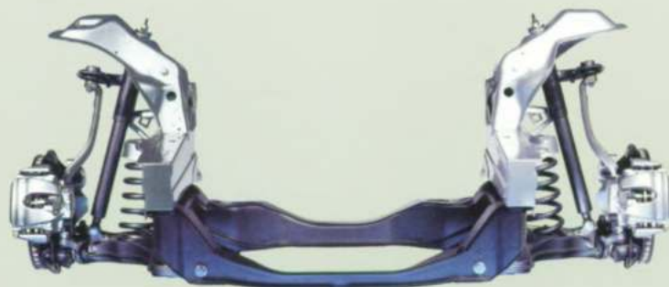
De vooras met dubbele wieldraagarmen verbetert niet alleen de veiligheid en het rijcomfort, maar ook het rijgedrag.
