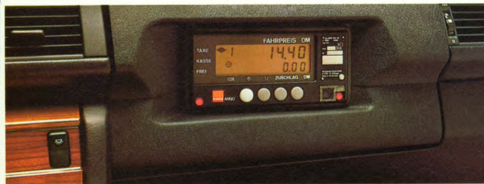
Standaard-uitvoering: Dashboardkastje voorbereid op de inbouw van alle type elektronische taxameters i.p.v.
