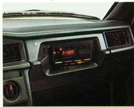
Dashboardkastje voorbereid op de inbouw van elektronische taxameters (190 D - 190 E 2.3).
