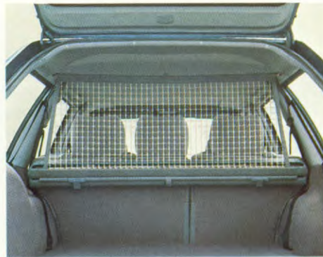
Een scheidingsnet beveiligt het interieur tegen losse bagage (extra bij T-serie).
