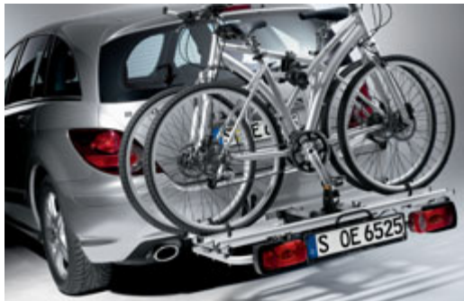
Bijzonder praktisch: de achterfietsdrager New Alustyle wordt op de trekhaak bevestigd. Dankzij een eenvoudig klapmechanisme kan de bagageruimte gewoon worden geopend.
