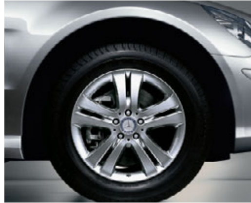
Standaard voor de V6-modellen, niet voor de R 300 CDI: 18-inch vijf-dubbelspaaks lichtmetalen velgen met banden 255/55 R 18.
