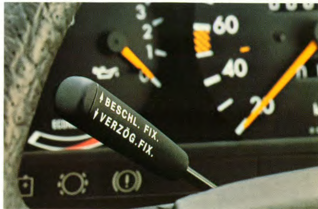
De tempomat houdt constant elke tevoren ingestelde snelheid van meer dan 40 km/u aan. (Tegen meerprijs, in combinatie met automatische transmissie).
