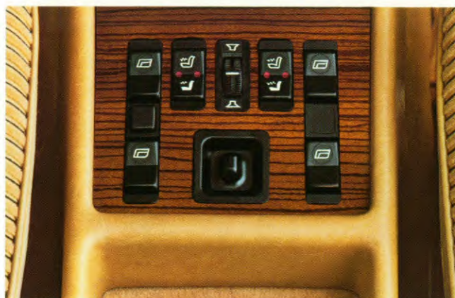
Elektrische zijruitbediening voor en achter, elektrische voorstoelverwarming met 2 standen (tegen meerprijs).
