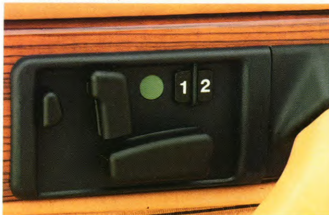
Met deze symbolischakelaars kunnen de voorzitplaatsen 8-voudig versteld worden. Ook de hoogte van de hoofdsteunen kan elektrisch versteld worden. Bovendien biedt de elektrische verstelling met geheugen de mogelijkheid om twee verschillende zitinstellingen exakt vast te leggen (speciale uitvoeringen).
