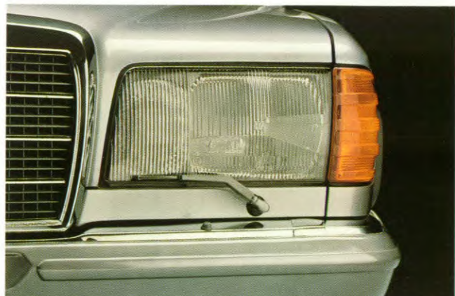
Geïntegreerde halogeen koplampunit met om de hoeken van de wagen geplaatste knipperlichten.
