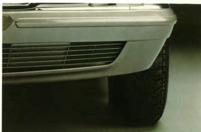
De bumpers vangen lichte schokken op zonder karrosserieschade.
