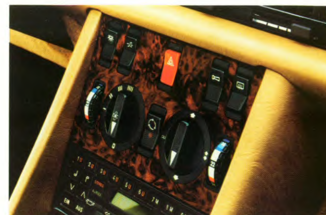
De airconditioning houdt de eenmaal ingestelde binnen-temperatuur constant en is links en rechts apart regelbaar (tegen meerprijs).
