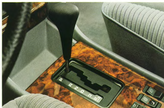
De nieuwe automaatschakeling met de extra remstand "B".
