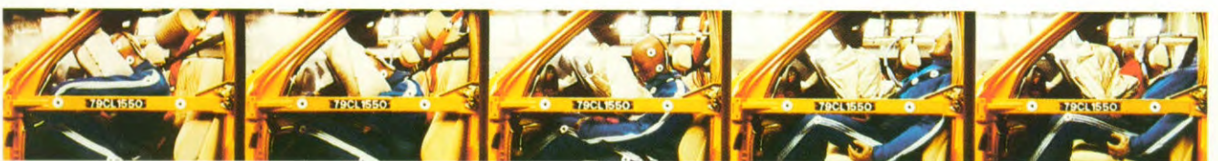
Elektronisch geregeld beveiligingssysteem met airbag (extra) en standaard gordelspanners.
