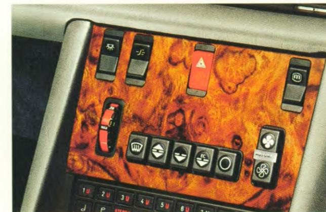
De elektronisch gestuurde automatische airconditioning houdt de ingestelde binnentemperatuur constant.
