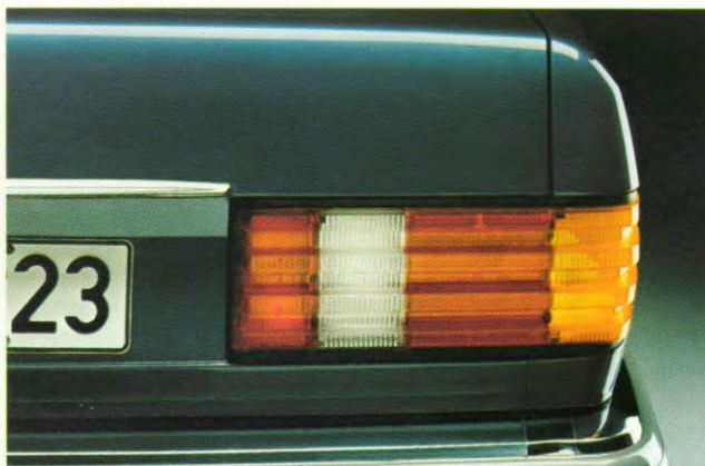
Achterlichten met karakteristieke vuilwerende dwarsribbels.
