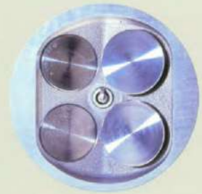
Vergeleken met de tweekleppen-techniek biedt de vierkleppen-techniek duidelijk grotere totale klepopeningen.
