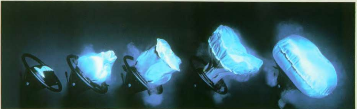
Onder normale omstandigheden merkt u niets van de aanwezigheid van de Airbag. Indien nodig, wordt deze in 30 millisekonden opgeblazen.
