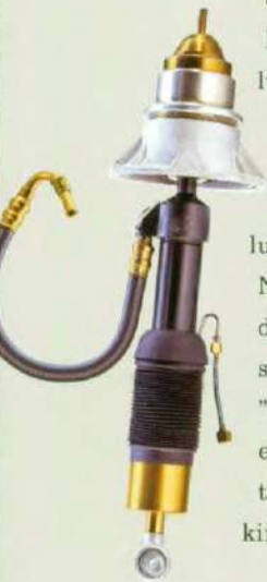
De niveauregeling zorgt voor een konstant wagenniveau.
