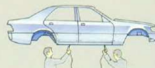
PVC-afdichting van de naden
