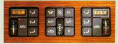
Twee "klimaatzones" in de auto: de airconditioning met automatische regeling.
