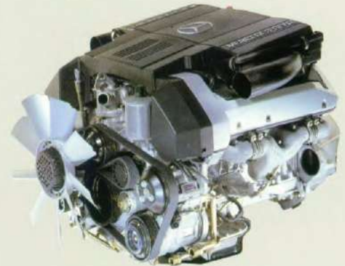
De acht-cilinder motor met 32 kleppen.
