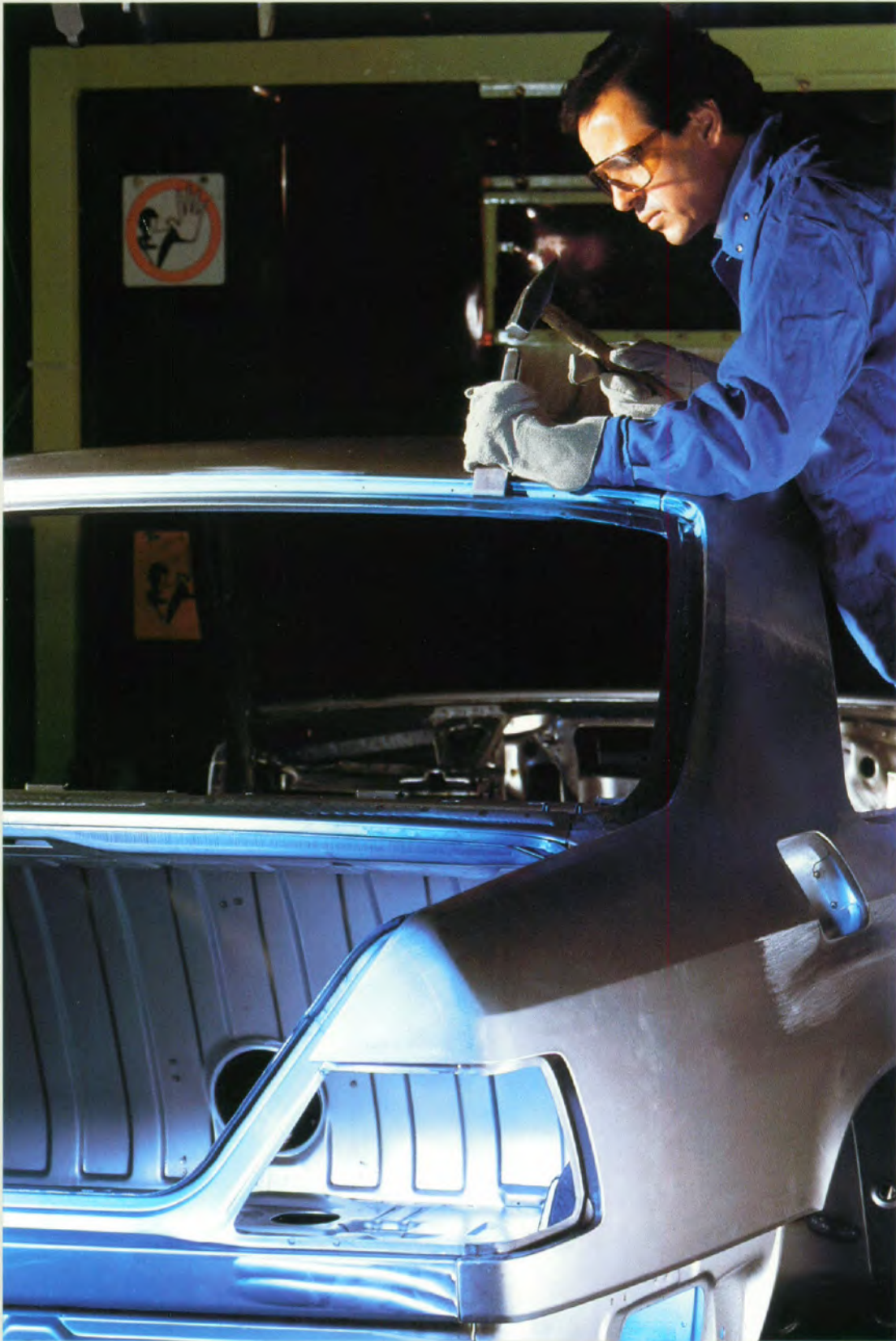
Bepaalde montagewerkzaamheden bij enkele modellen worden met de hand verricht. Zoals bijvoorbeeld de montage van het dak.
