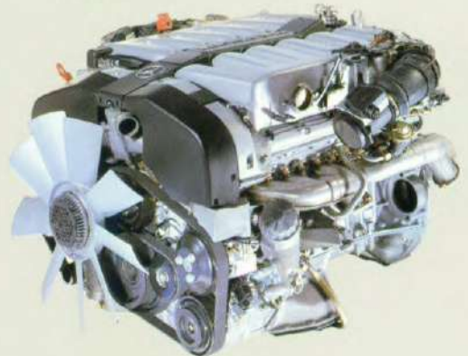
De twaalf-cilinder motor met 48 kleppen.
