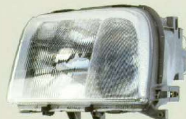
De multi-vlaks reflectoren zorgen voor een nog betere verlichting.
