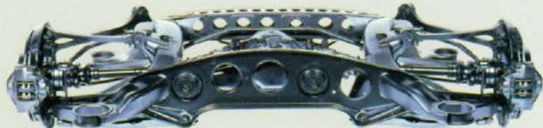
De vooras met dubbele wiel- draagarmen zorgt voor een beter rijgedrag.
