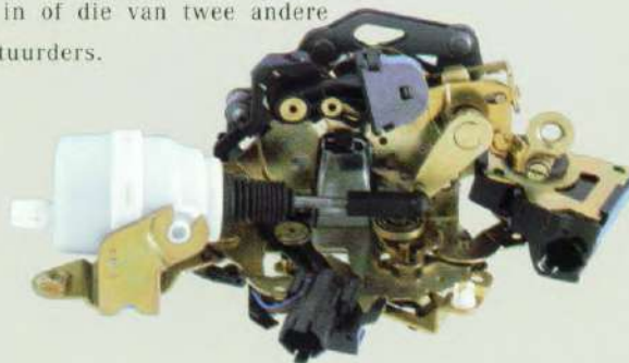
De sluitbekrachtiging sluit de deuren moeiteloos.
