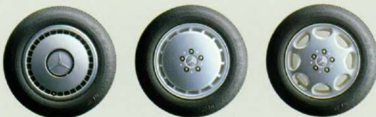
De verschillende velgen van de S-klasse: stalen velgen, gegoten lichtmetalen velgen en gesmede lichtmetalen velgen.
