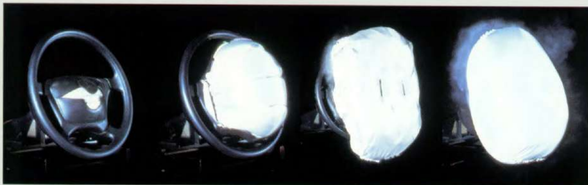
Onder normale omstandigheden merkt u niets van de aanwezigheid van de Airbag. Indien nodig, wordt deze in 30 milliseconden opgeblazen.
