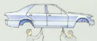
PVC-afdichting van de naden
