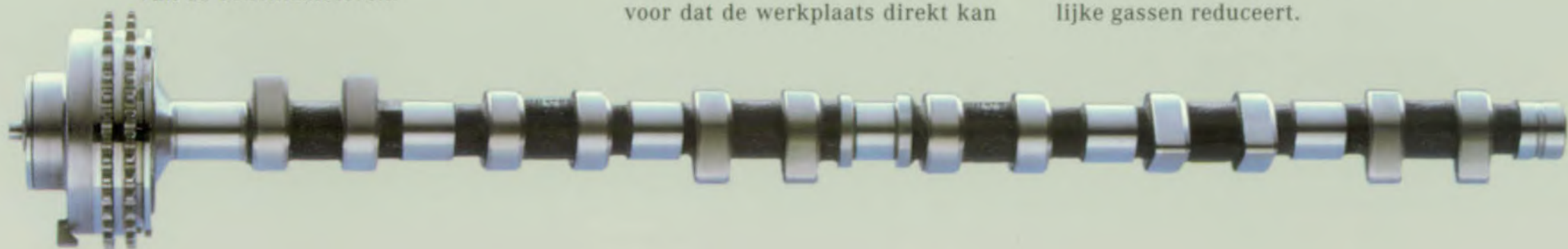
De verstelbare inlaat-nokkenas van de benzinemotoren.
