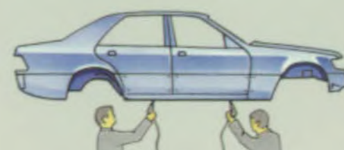
PVC-afdichting van de naden
