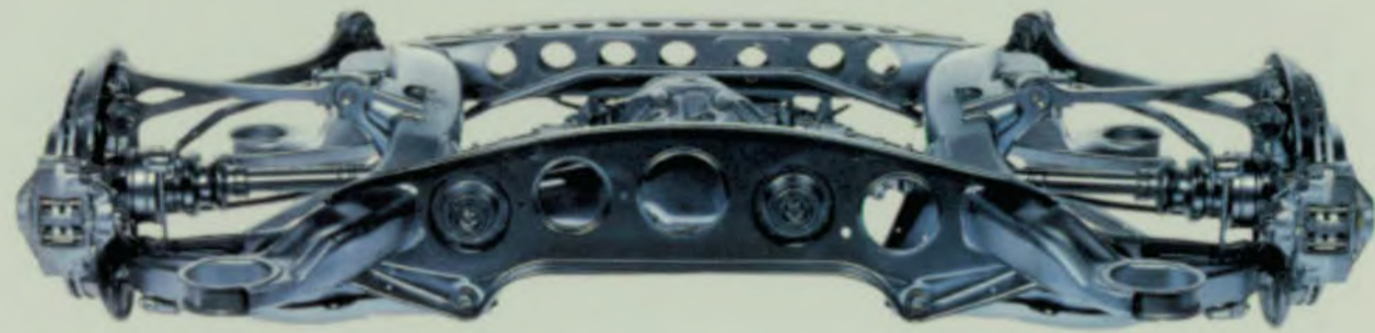
De vooras met dubbele wieldraagarmen zorgt voor een beter rijgedrag.
