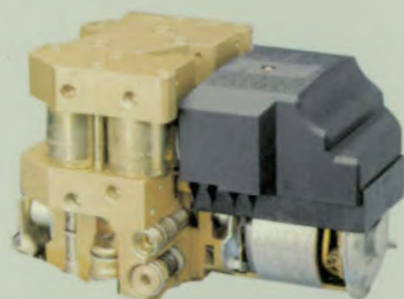
De ABS/ASR-regelunit voorkomt doorslippende en blokkerende wielen.
