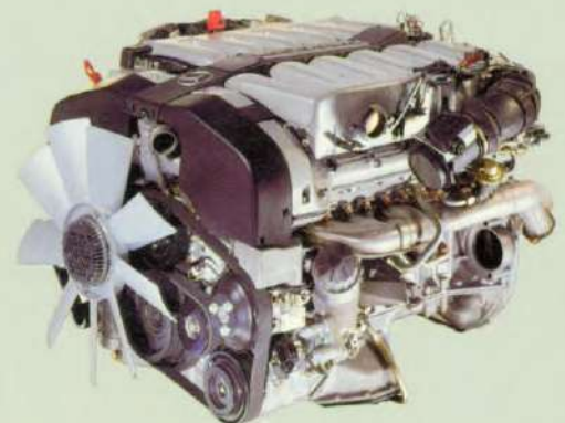
De twaalfcilinder motor met 48 kleppen.
