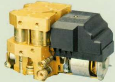
De ABS/ASR-regelunit voorkomt doorstippende en blokkerende wielen.
