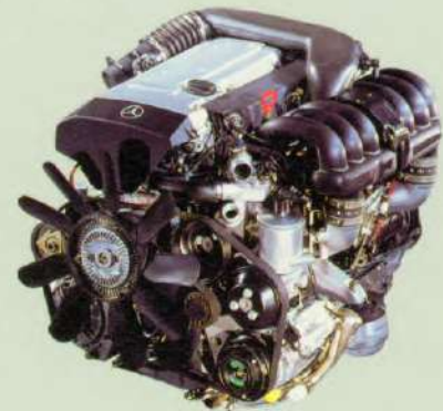
De zescilinder motor met 24 kleppen.
