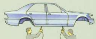
PVC-afdichting van de naden
