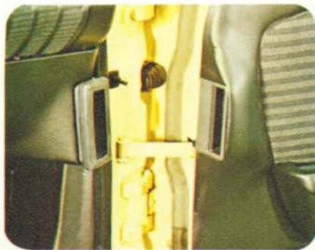
Durch einen Luftkanal sind die Vordertüren an das Heizungs- und Lüftungssystem angeschlossen.
