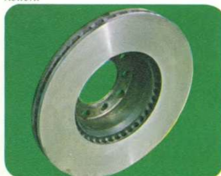
Zweikreis-Servo-Bremssystem mit Scheibenbremsen an allen vier Rädern. Vorn: innenbelüftete Bremsscheiben.
