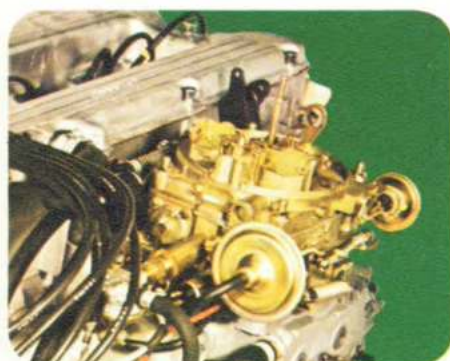
Doppelregister-Vergaser des 280 S: hervorragende Gemischbildung und sehr gute Abgaswerte.
