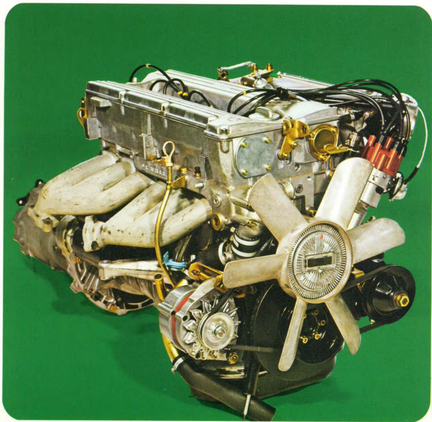
280 SE: 6-Zylinder-Motor mit zwei obenliegenden Nockenwellen, elektronisch gesteuerter Benzinein- spritzung und Transistor-Zündung. 185 PS/DIN bzw. 136 kW.
