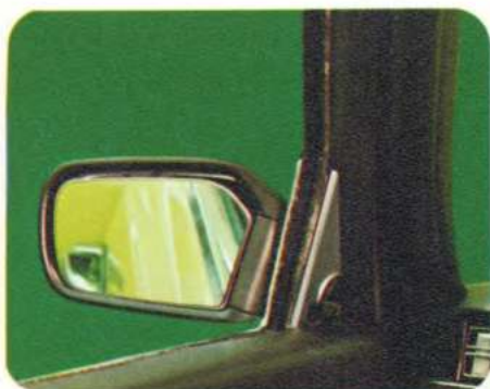
Der Außenspiegel ist bei geschlossenem Seitenfenster von innen einstellbar.
