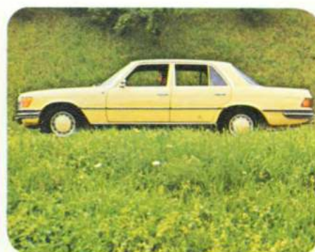
Mit dem um 11,5 cm verlängerten Radstand (gegenüber den Vorgänger-Modellen) wurde der Fahrkomfort weiter verbessert.
