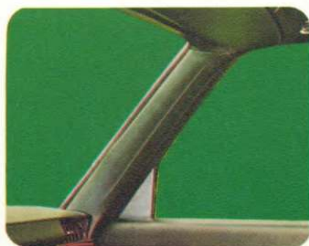
Hoher Überrollschutz durch eine gründlich getestete Dachkonstruktion, deren Festigkeit nach ESEM (Elasto-Statik-Element-Methode) berechnet wurde.
