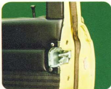
Das bewährte Mercedes-Benz Sicherheitszapfenschloß wurde weiter verbessert. Das Schloß kann jetzt bis 3000 kg belastet werden.
