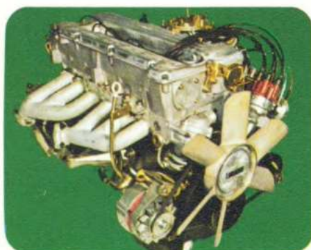
280 S: 6-Zylinder Motor mit zwei obenliegenden Nockenwellen und Doppelregister-Vergaser. 160 PS/DIN bzw. 118 kW.
