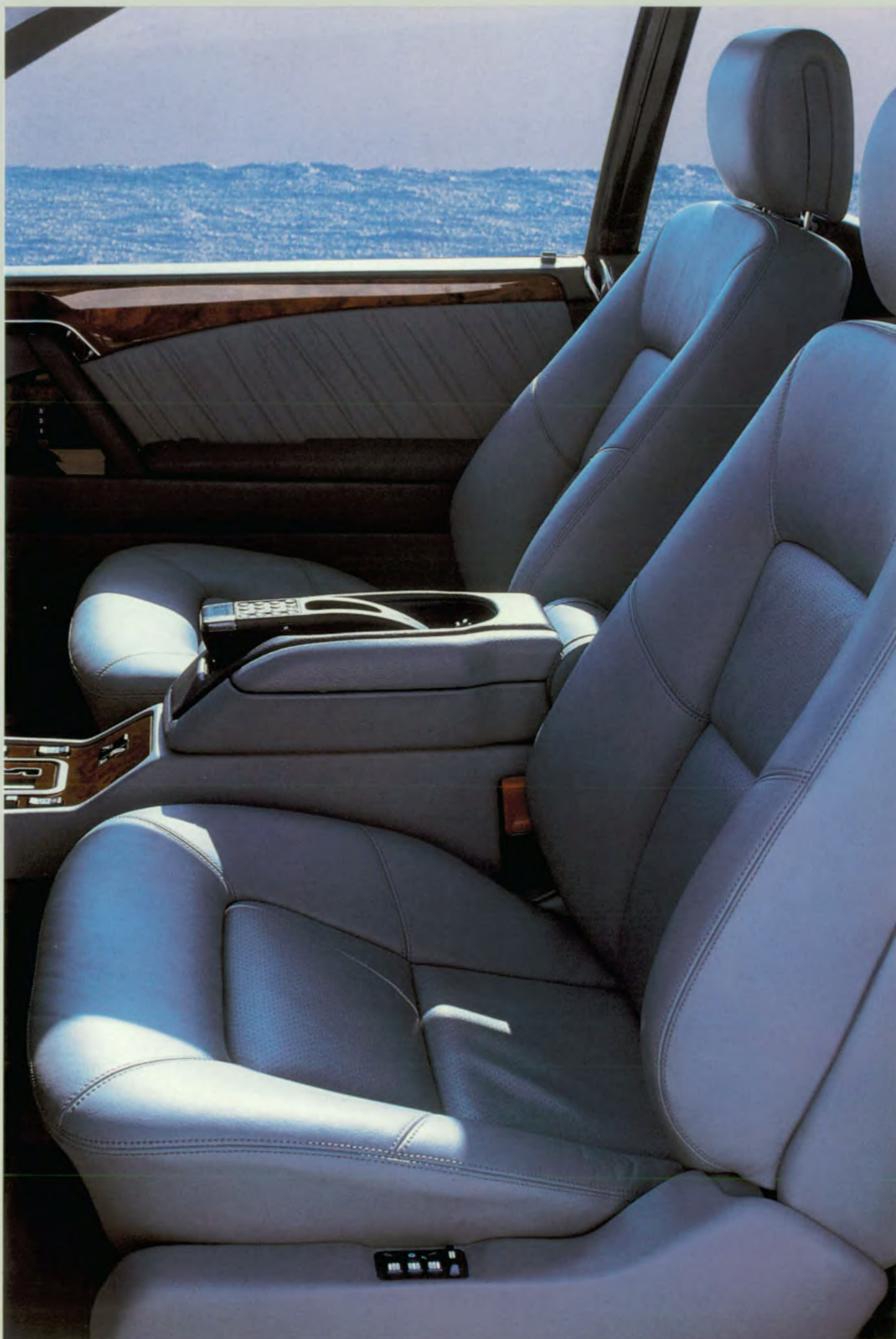
De voorzitplaatsen hebben een uitgesproken kuipvorm en zijn voorzien van een lendensteun.
