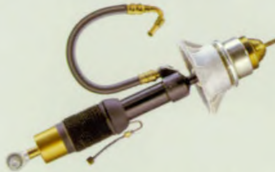
De niveauregeling zorgt voor een konstant wagenniveau.
