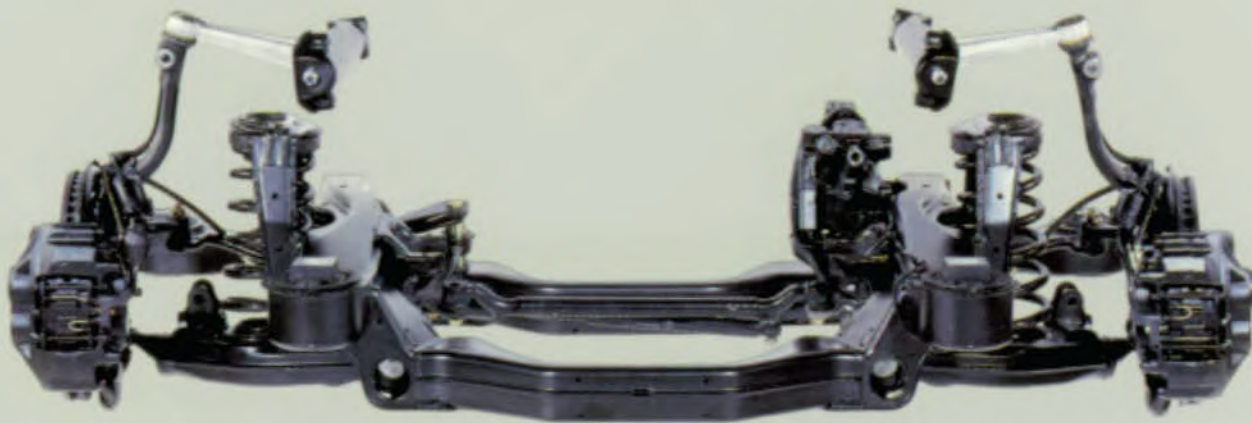
De vooras met dubbele wieldraagarmen zorgt voor een nog beter rijgedrag
