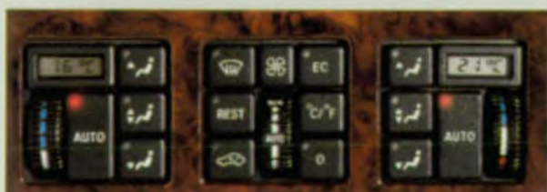
Twee "klimaatzones" in de auto: de airconditioning met automatische regeling van de S-klasse Coupé.
