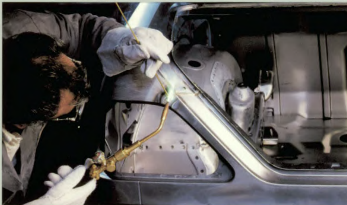
Ter wille van de kwaliteit wordt het achterpaneel van elke S-klasse Coupé handmatig gelast.
