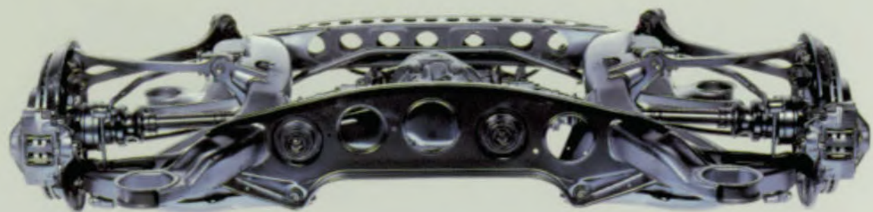
De ruimtelijk geleide achteras beperkt eigen stuurbewegingen en houdt de S-klasse Coupé exact op de juiste koers
