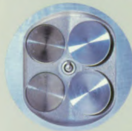
Ten opzichte van de tweekleppen-techniek biedt de vierkleppen-techniek meer vermogen en een hoger koppel.
