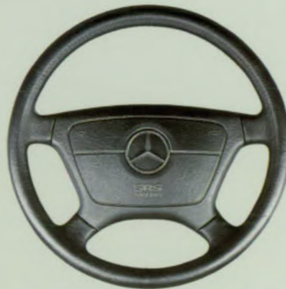
Onder normale omstandigheden niet te zien, maar als ze nodig zijn in 0,03 seconden paraat: de standaard Airbags voor de bestuurder en de voorpassagier.
