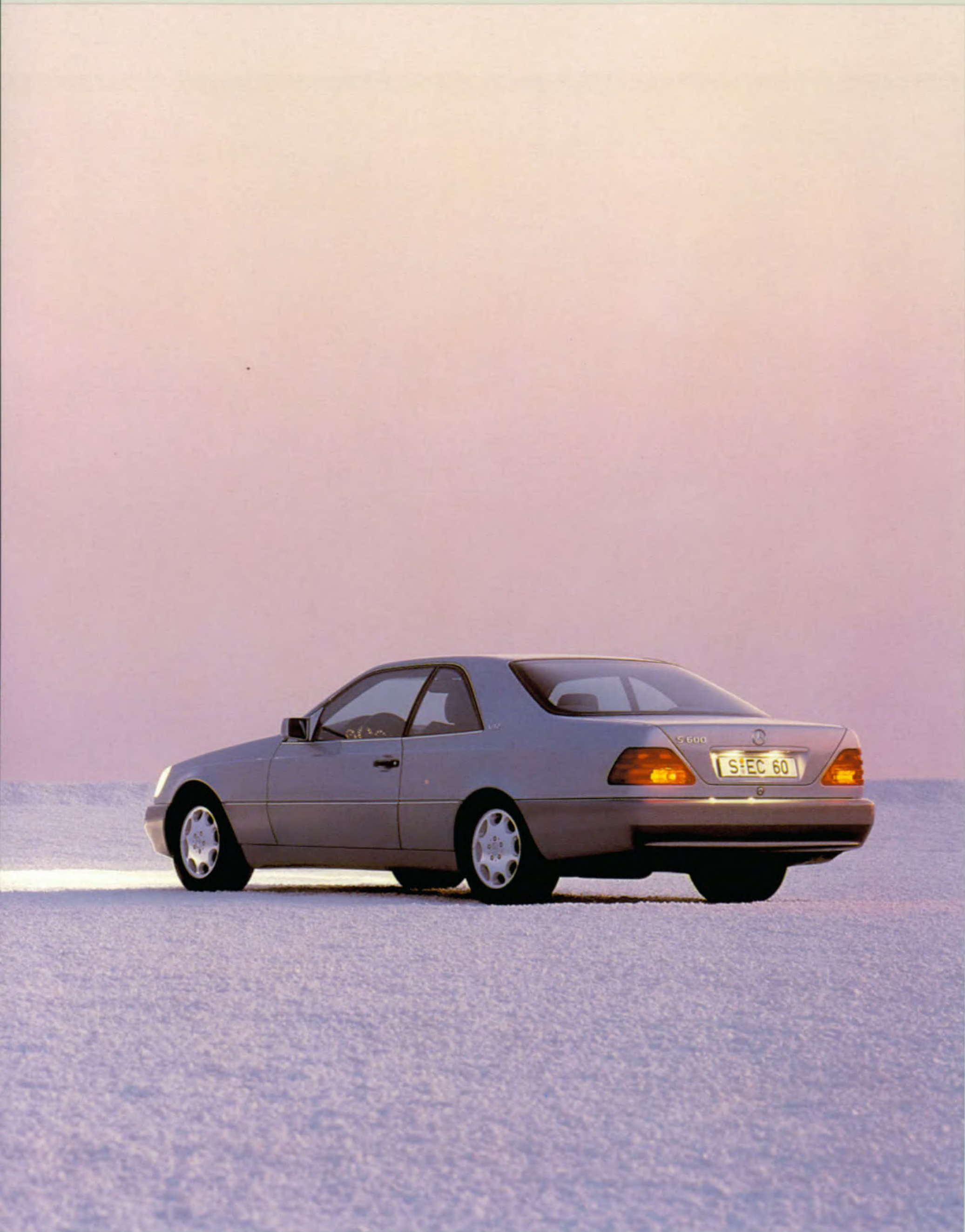
De achterlichten werden volledig in het achterpaneel geïntegreerd.
