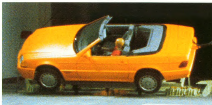
De SL bij de koprol-test. De rolbeugel komt nog niet in beeld. Maar een schakelaar aan de rechter veerarm van de achteras
