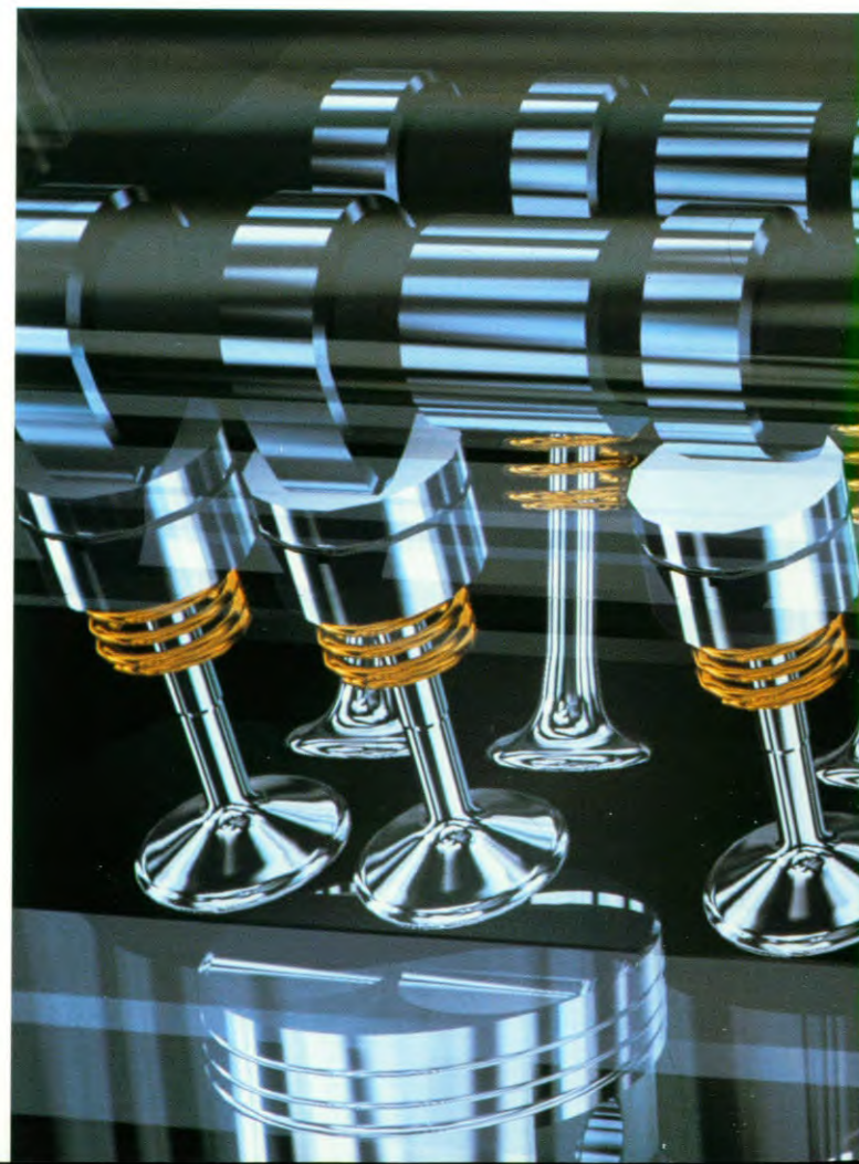
Door de verstelling van de inlaatnokkenassen wordt ook in het lage- en middentoerengebied een optimale cilindervulling en daarmee een hoog koppel bereikt.
