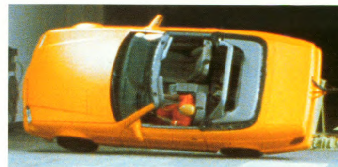
frakties van een seconde later: de in het startapparaat geïntegreerde kantelhoekschakelaar geeft de elektronika het signaal,
