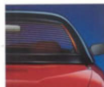
Voor maximaal zicht onder alle weersomstandigheden is de hardtop voorzien van een verwarmbare ruit.
