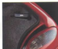
De hendel voor de ontgrendeling van de bagageruimte voorin de auto bevindt zich voor alle zekerheid in de kofferruimte. En die kan enkel met een sleutel worden geopend.
