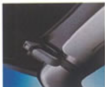
De twee sluitingen aan de voorzijde van het dak zijn eenvoudig te ontgrendelen.
