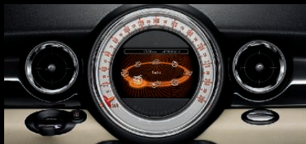
In combinatie met het MINI navigatiesysteem of de MINI Radio Visual Boost is de snelheidsmeter uitgevoerd als buitenring van het centrale instrument.
