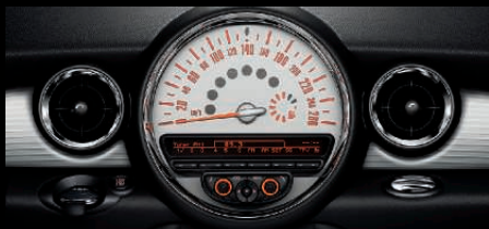
In de grote, centraal in het dashboard geplaatste snelheidsmeter bevinden zich waarschuwings- en controlelampjes en de brandstofmeter.
