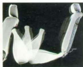
Het mechanisme van de neerklapbare achterbank-hatchback
