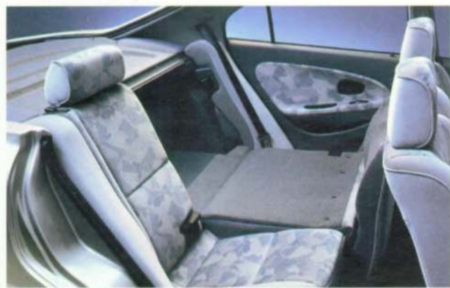
Het mechanisme van de neerklapbare achterbank-hatchback
