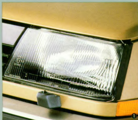
De Colt 1600 Turbo heeft hogedrukreinigers op de koplampen.
