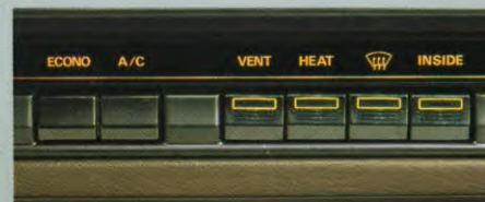
Op het dashboard bevinden zich de toetsen voor ventilatie en verwarming (GLS).
