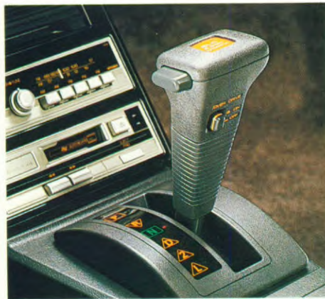
4-traps automaat waarvan de vierde een uitschakelbare overdrive
