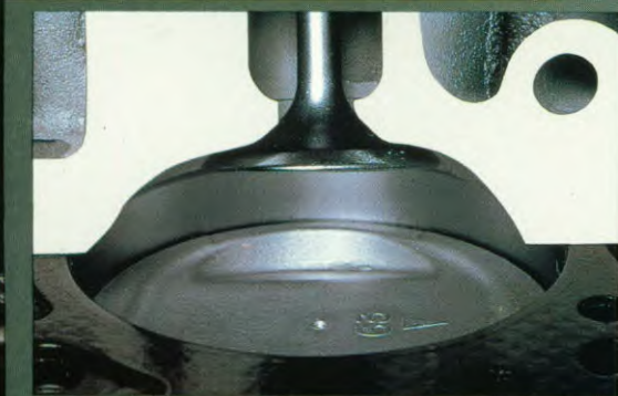
Een nieuw ontwikkelde verbrandingskamer zorgt voor een schonere en zuiniger verbranding.
