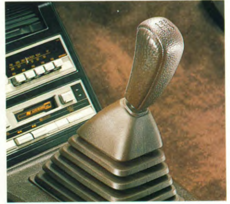
5-versnellingsbak waarvan de vijf een overdrive is
