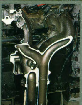
Dubbel uitlaatsysteem levert meer rendement.
