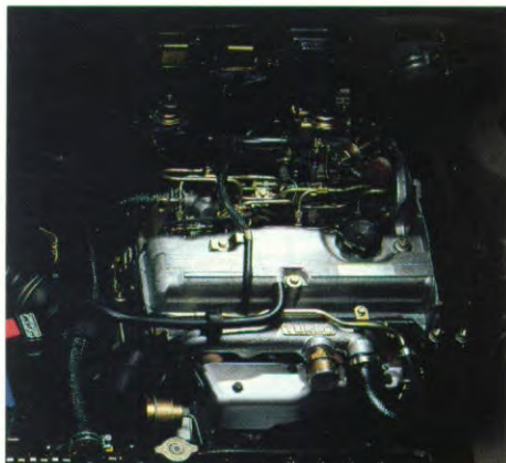
1.8 liter Turbo Diesel motor met Intercooler (vermogen 60 kW/4500 rpm)
