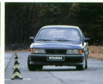
Dynamische ECS controleert/reduceert het overhellen van de auto tijdens het snel nemen van bochten.
