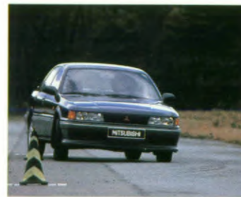
Dynamische ECS controleert/reduceert het overhellen van de auto tijdens het snel nemen van bochten.
