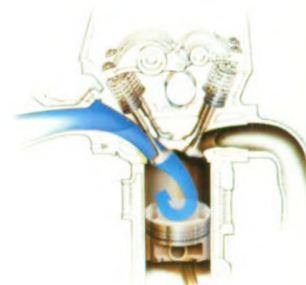
Ideale brandstof-zuurstofmenging door meervoudige injectoren.
