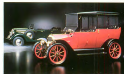
De allereerste Mitsubishi, Model A. Daarachter de Mitsubishi 4WD PX33 convertible met een 6-cilinder 4390 cc dieselmotor uit 1934.
