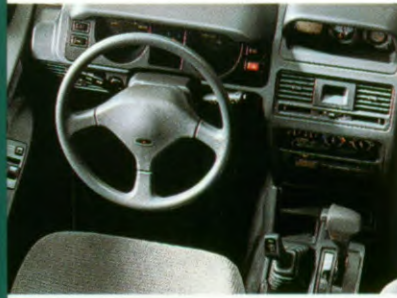
Dashbord compleet met hellingshoekmeter en hoogtemeter.
