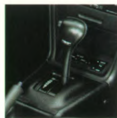
▲ Keuzeschakelaar met 3 verschillende standen voor de automatische transmis- sie: P voor sportief rijden, C voor comfor- tabel rijden en A/T voor automatische selectie van schakelpatroon P of C.
